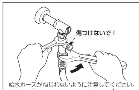
7. 給水ホースをソケットに差し込み、クリップを差し込みます。
